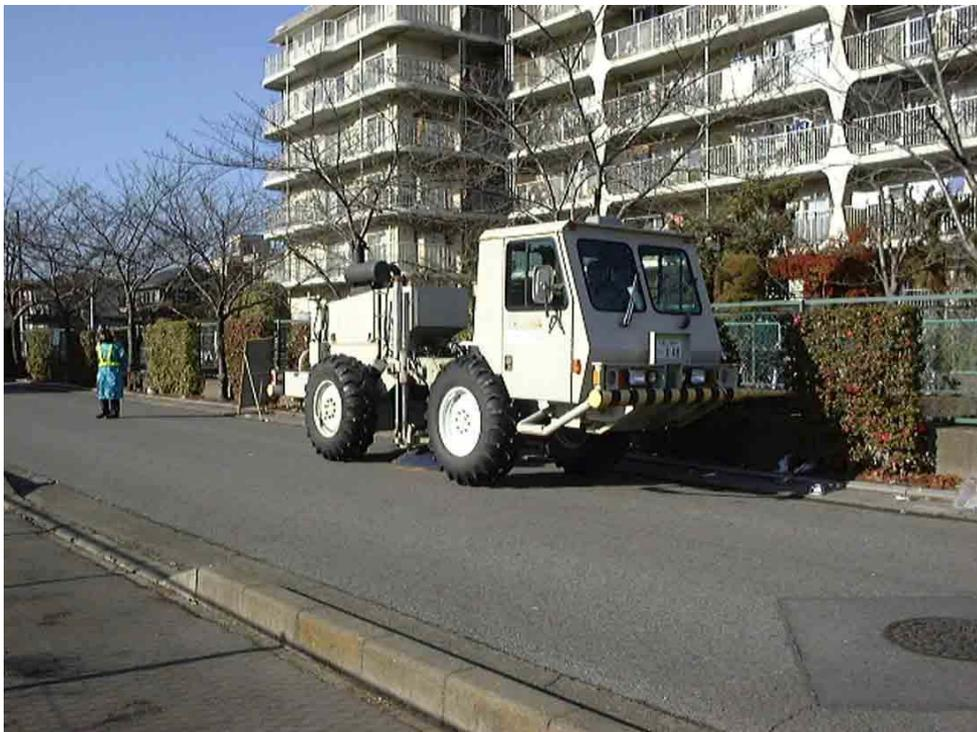
図 5b ミニパイプによる発震状況（人家からの距離により大型パイプロサイズが発震困難な箇所では、ミニパイプによる発震を行った。）
