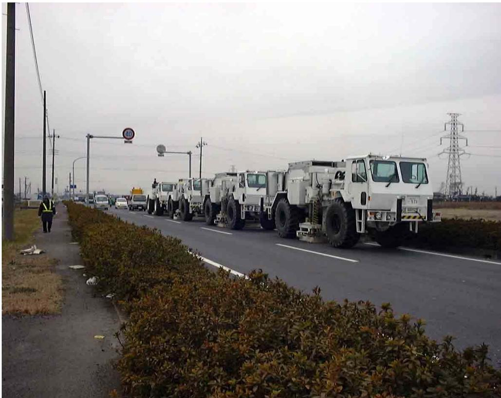
図 4b. バイブロサイスの発震状況 (北関東測線: VP1155)
