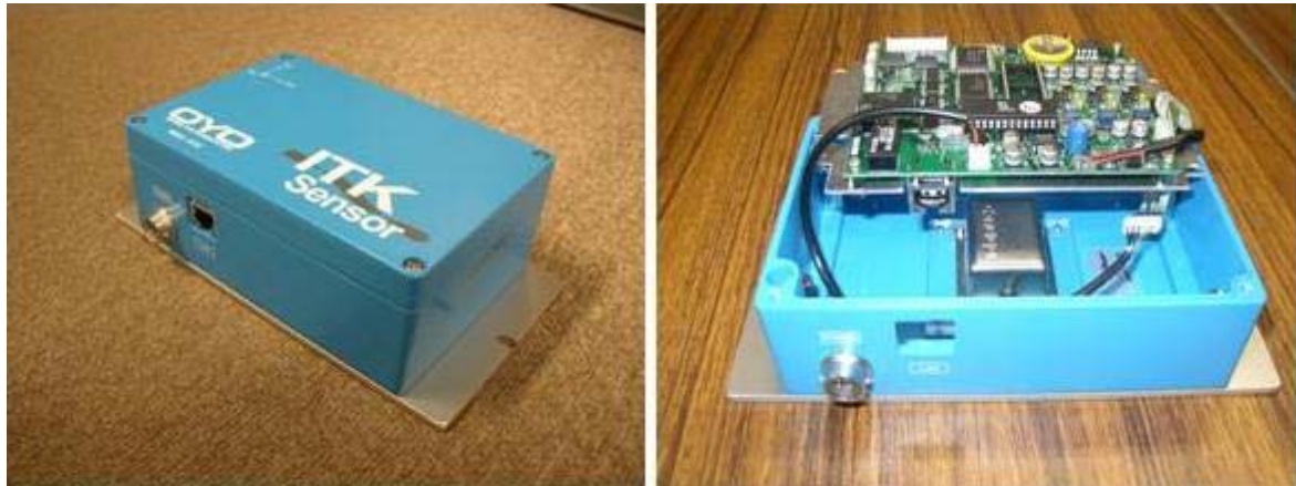
図2 廉価版LAN接続型強震計(IT強震センサー:試作品)
