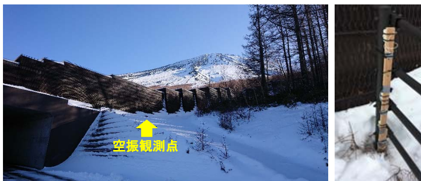
富士山青草洞門上に設置された空振点(左)と、5合目付近に設置された積雪内の温度勾配測定観測装置(右)
