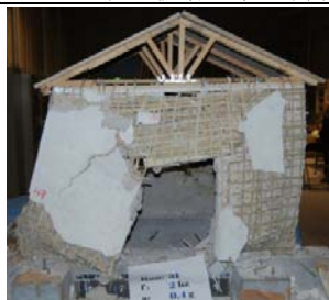
図 3.4d 竹-バンドメッシュ補強 組積造の振動台実験
