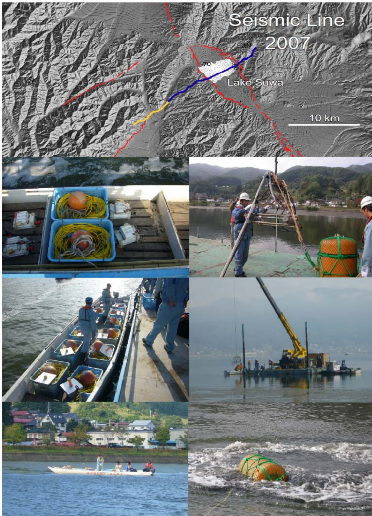
諏訪湖を横断する地震探査観測。 上図は探査側線。 その下6枚の写真は、ベイケーブルの敷設と湖上でのエアガン発震作業。
