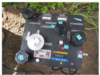
(5) 測定開始: ダイヤルを回して検流計の針が $0 \mu$  Aになるように調整し、値を読み取る.
