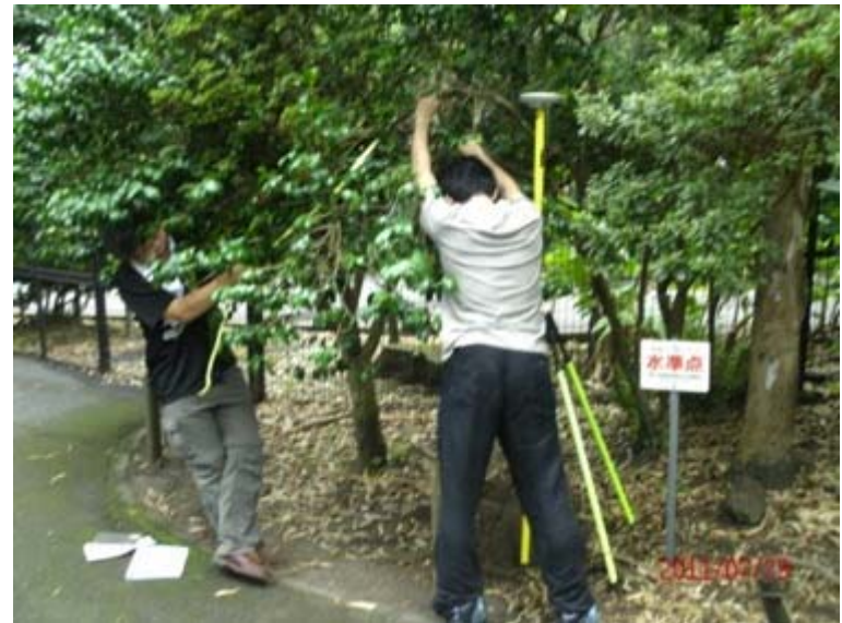
アンテナの上の邪魔な木をどかし ながら測定
