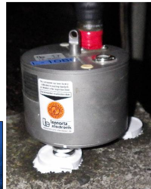
石膏で固定した地震計
