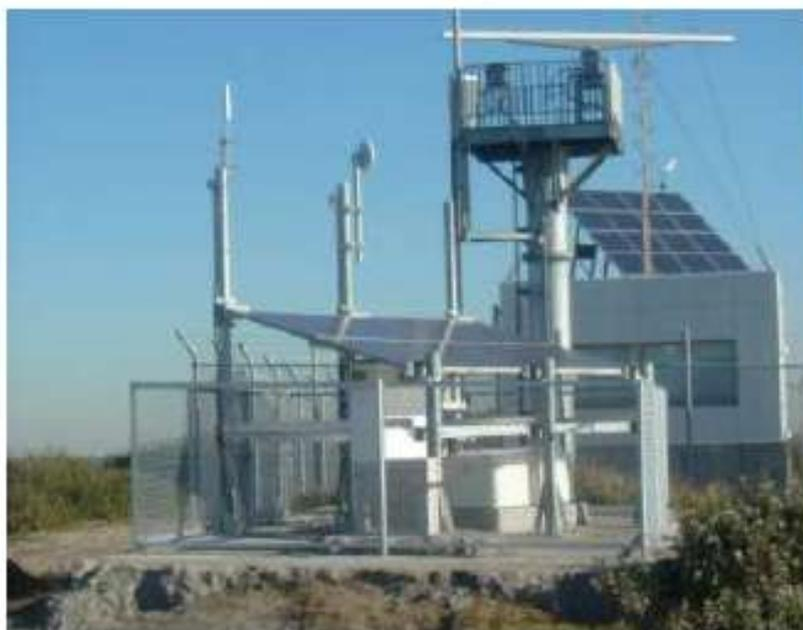
図2. 第二海堡地震観測点の完成状況.フェンス内には30mボーリング孔と各種観測装置の収納ボックス、太陽電池パネルの上部支柱には、GPSとデータ送信用のアンテナが設置されている。後方には、国土交通省の波浪観測所が見える。
