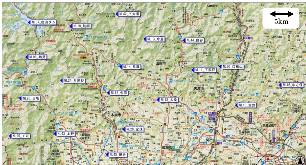
図 1: 衛星テレメータ地震観測網
