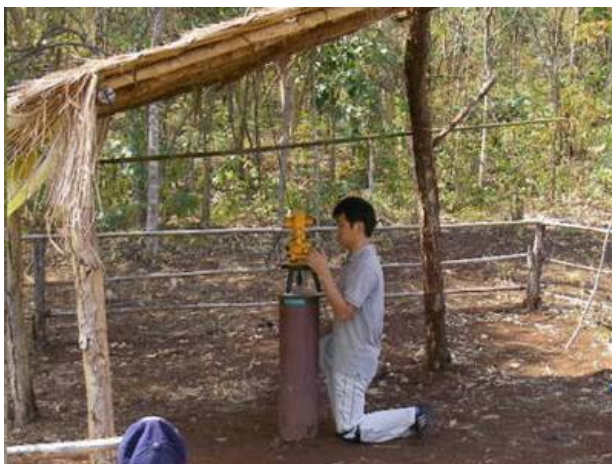
写真 1 : Kanchanaburi 観測点にて、 FT 型磁気儀を操作しているところ
