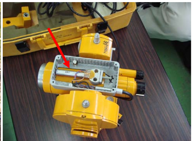
写真 2 : FT 型磁気儀に取り付けられている、 FluxGate センサー部
