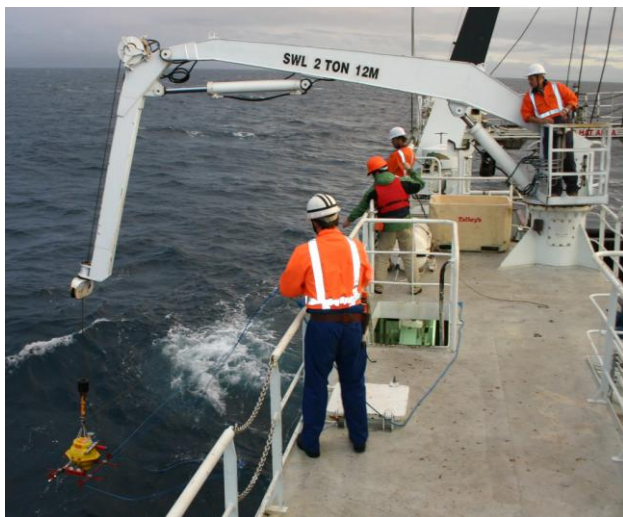
図 4 海底地震計を海に投入する直前の状況。図の左下にある黄色の機器が海底地震計。
