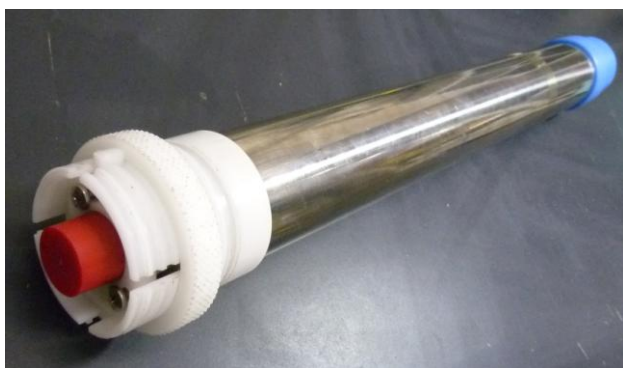
図 3 音響式トランスポンダ装置の耐圧容器に取り付けた、耐圧容器の蓋を容易に引き出すためのデルリン製整備治具（白い部品で構成されている箇所）。
