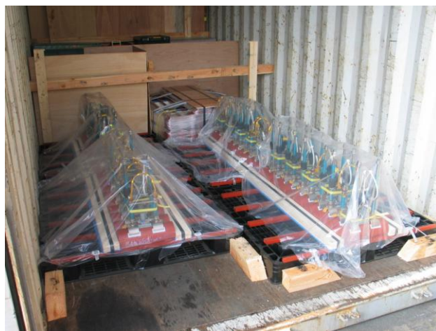
図 2 コンテナに積み込んだ海底地震計の錘とその切り離し部。輸送中に切り離し部が損傷しないように PP バンドと金属バンドを併用して錘を固定している。
