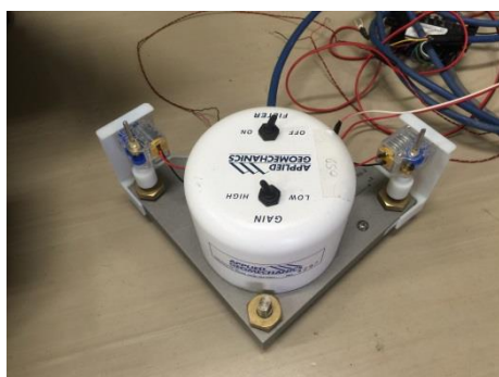
写真 3. 傾斜計に製作した治具を組み付け
