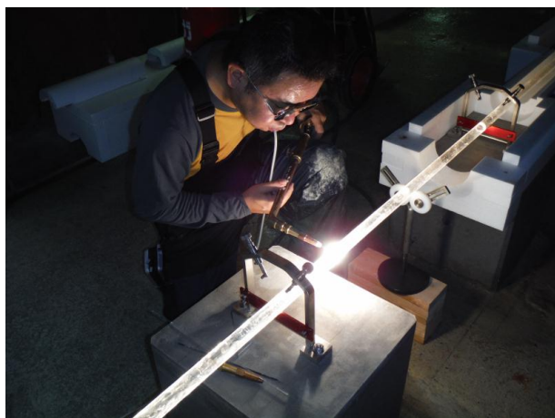
写真 3 石英管伸縮計の溶接の様子
