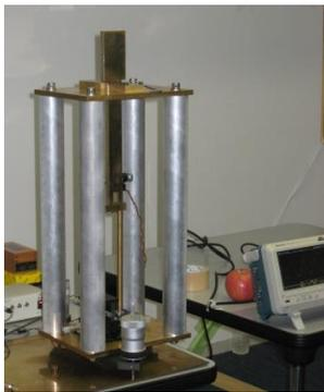
図1 学生実験用に製作した重力計
