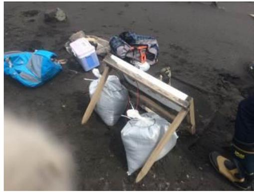
図.8 ソーラー架台の補強
