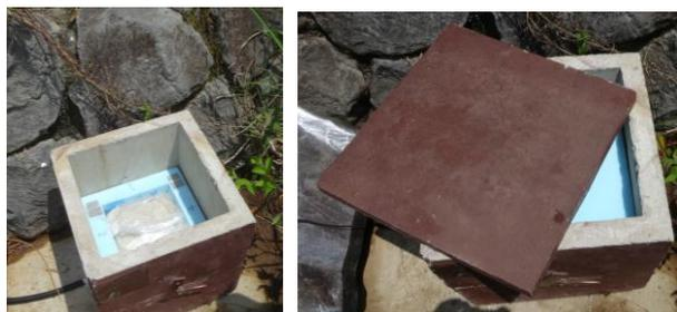
図 5: 断熱対策を施した地震計用集水枡の内部
