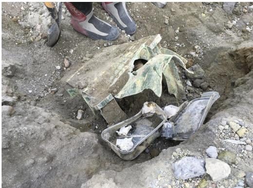
図 2-1. 火口カメラ制御装置の収納ケース
