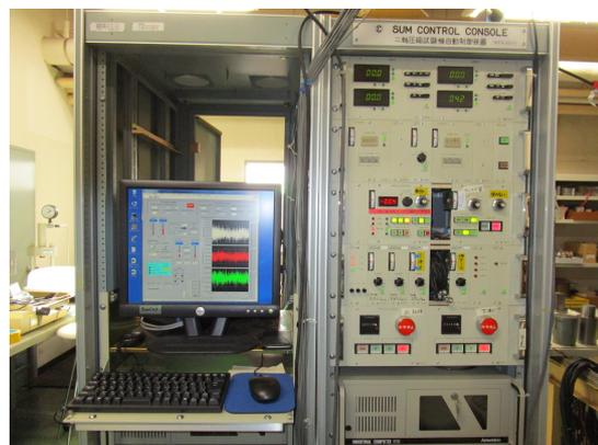
写真：二軸圧縮試験機の制御部
