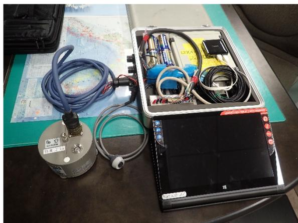
図. 左からレナーツ、CAL 専用ケーブル（スイッチ付き）、ロガー等を収めた BOX、windows タブレット。
