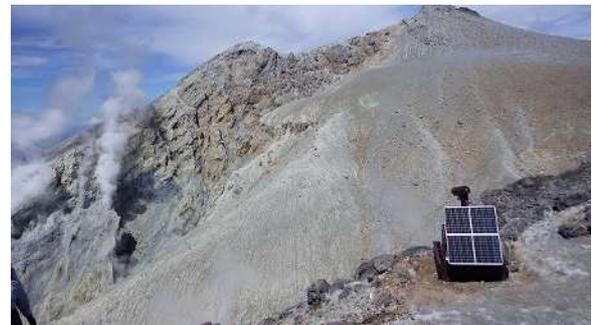
写真 2 火口監視カメラ外観（御嶽山の例）
