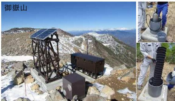
写真 1 広帯域地震計観測施設外観（左）とセンサー（右上：CMG-31、右下：センサー孔充填材）
