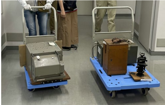
図 2. 譲り受けた萩原式電磁地震計（HES）の記録部（左）と南北動地震計（右奥），及びアストロコンパスとその木箱（右手前）
