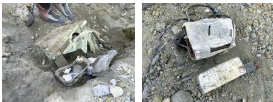
図 3. 熱で溶けた収納箱と PC など
