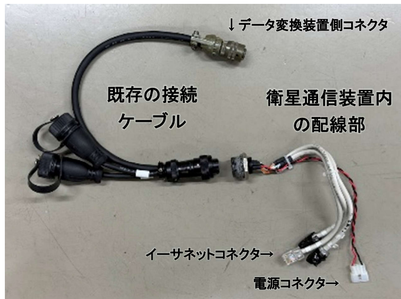
図 6. 工作した電源・通信ケーブル
