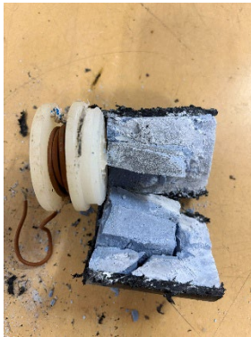
図 4. 分解後の電極
