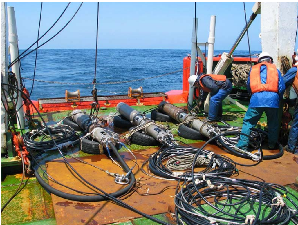
写真1 三陸沖北部から十勝沖の浅部構造調査のために使用したエアガン(平成19年5月)
