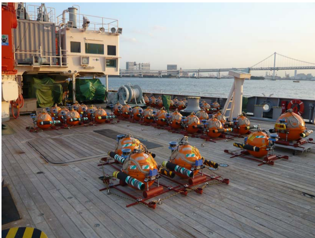
写真4 三陸沖に設置される海底地震計（平成19年10月）
