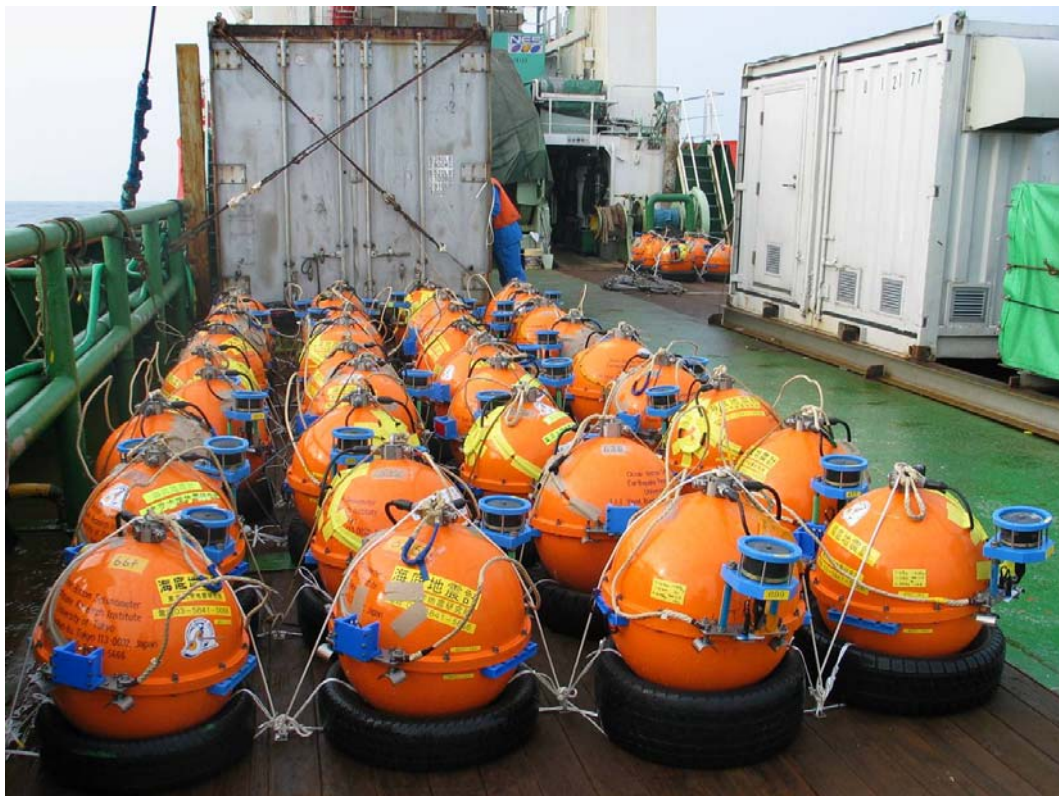
写真3 三陸沖北部から十勝沖から回収作業中の海底地震計（平成19年6月）
