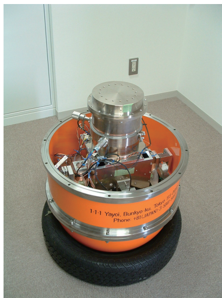
写真2 真空容器に収納された重力偏差計。重力センサ2台を50cmの垂直距離を隔てて円筒状の真空容器に収納し、重力偏差計として機能させる。ジンバル機構により、鉛直が保たれる。
