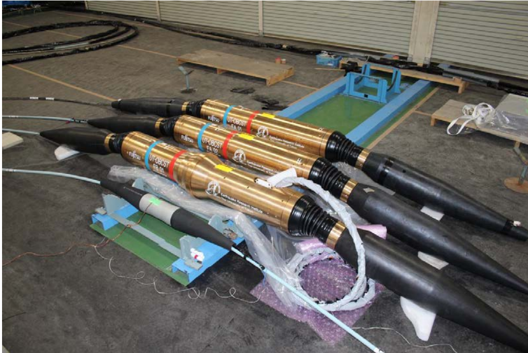
図3 観測装置の外観。奥の2台が内部に地震計と津波計を内蔵した観測装置。手前から2台目が、外部観測装置を接続することのできる拡張ポートを備えた観測装置。一番手前は、海底ケーブル同士を接続するために用いるもので、観測装置ではない。観測装置の直径は約26cm、長さは、黒い部分を除き、約1.3mまたは約1.5m。接続されている光海底ケーブルには、光ファイバーと電力を供給する導体が入っている。
