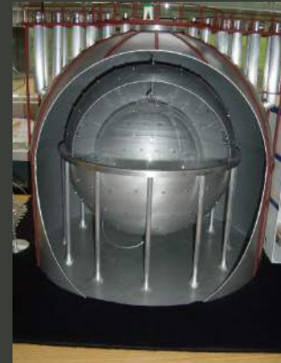
Borexino (> 2007) Liquid scintillator 0.3 kt, 2200 PMTs
