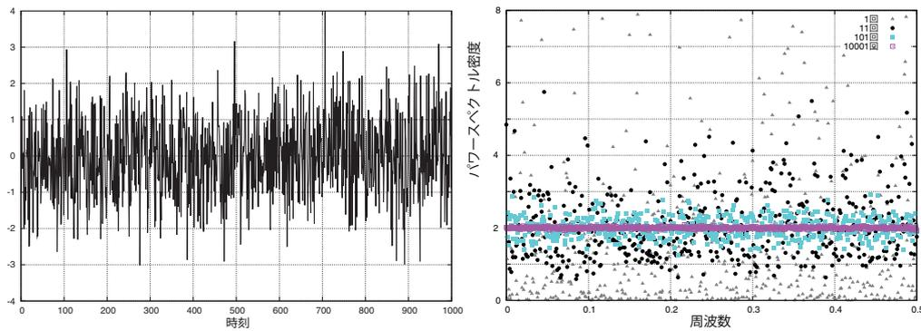
Figure 3: 図左:白色雑音の時系列。図右:スペクトルをとりパワースペクトルを計算した結果。アンサンブル平均をとる数を増やす毎に、推定値は1に近づいていく。
