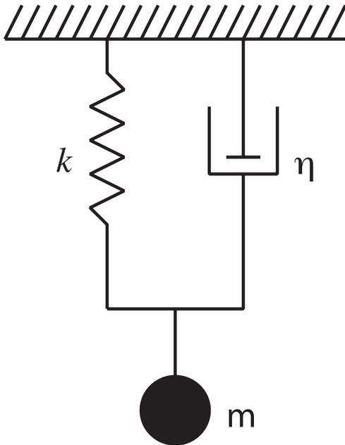
Figure 5: 地震計の概念図
