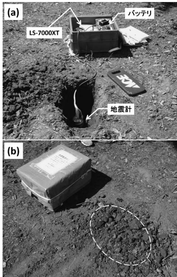
図6. 機動観測装置を用いた地動ノイズ調査。(a) 観測準備の様子。地震計は約0.5m埋設し、LS-7000XTデータロガーとバッテリはコンテナボックスに収納される。(b) 観測中の様子。破線枠内に地震計が埋設されている。
