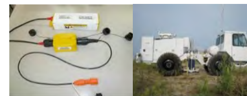
(左) 独立型レコーダー (右) バイブレータ型震源 (下) 高精度浅層反射断面
