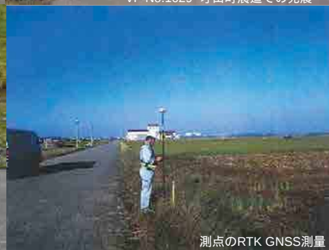
測点のRTK GNSS測量
