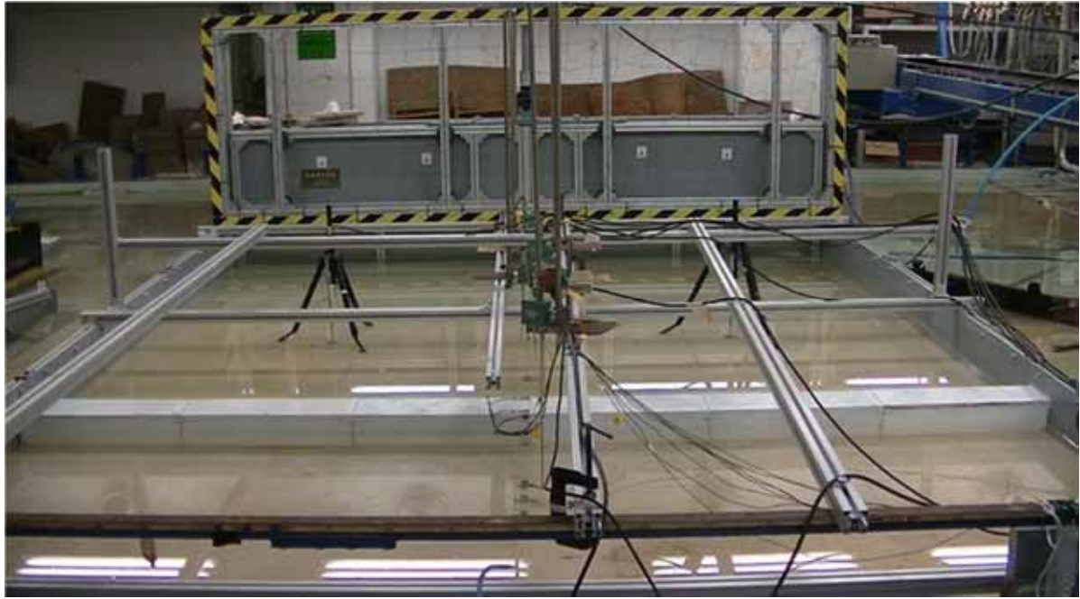
図 4 実験に用いた平面水槽および造波装置
