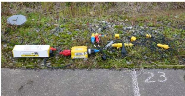
図 16 本サブサブテーマで使用した独立型地震波収録器の設置の様子。黄色・白色の箱形の機器が収録器とリチウムイオン電池。ここでは受振点1箇所につき地震計3台のバンチングを行い、3 ch の収録を行っている。
