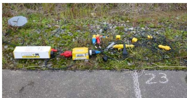
図 13 本サブサブテーマで使用した独立型地震波収録器の設置の様子。黄色・白色の箱形の機器が収録器とリチウムイオン電池。ここでは受振点 1 箇所につき地震計 3 台のバンチングを行い、3 ch の収録を行っている。
