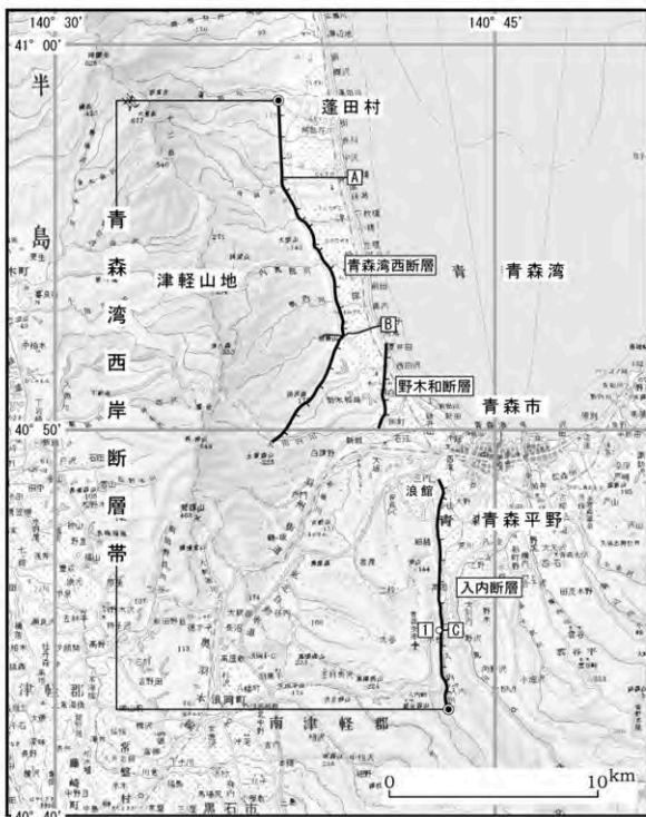
図2 青森湾西岸断層帯の活断層位置と主な調査地点 1: 小館地点 A-C: 反射法弾性波探査測線 (文献1) ●: 断層帯の北端と南端 活断層の位置は文献2に基づく。 基図は国土地理院発行数値地図200000「青森」を使用。
