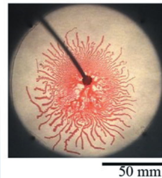
図3 粘弾性体の界面進展実験。透明な薄い準二次元的セル内部にチューブで粘弾性体を吹き込むと、遅い運動と速い運動が同時に進行していく。
