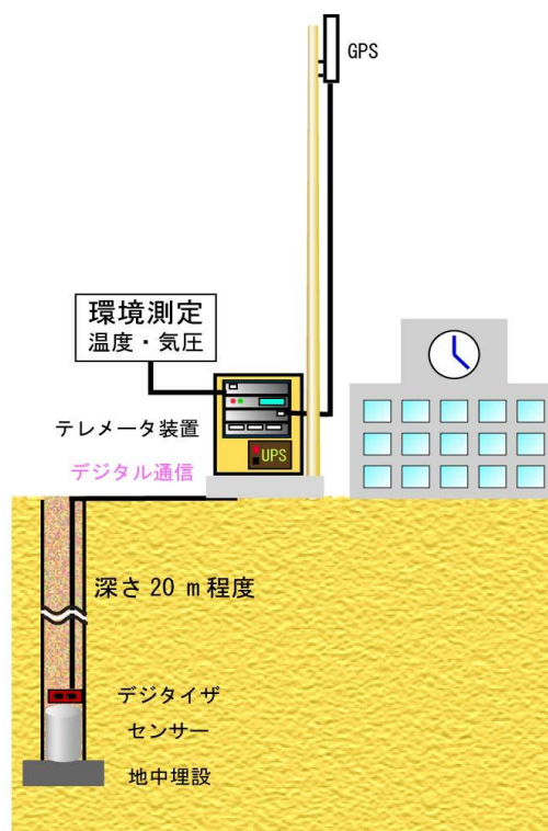
図 2 観測点の概要。地下 20m の深さに地震計が設置され、その信号をテレメータ装置が、地震研究所へ 24 時間 365 日連続して送信している。
