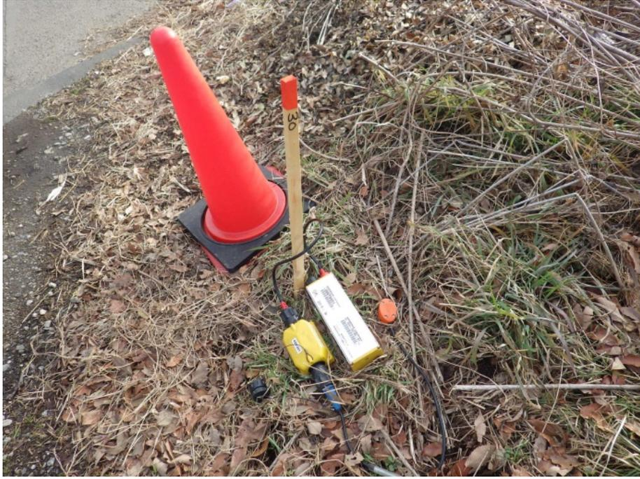
図4 独立型収録機器（GSR-1）の設置の様子。
