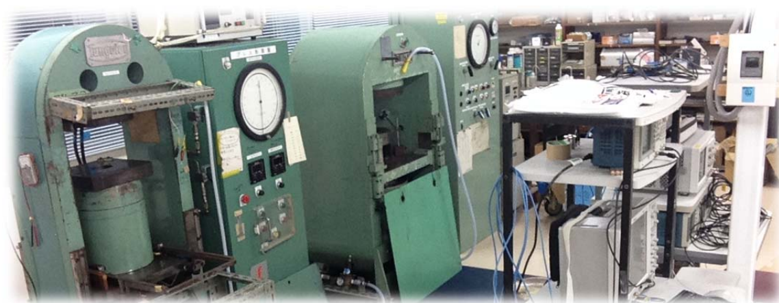
図 2 弾性波測定装置。ピストンシリンダー型高圧発生装置（左上）と従来の高圧セルシステムの一例（左下）。今回設計した高圧セルシステム。
