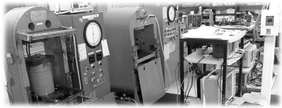
図1 ピストンシリンダー型高圧発生装置を用いた弾性波測定装置。
