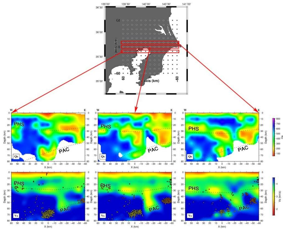
図1 S波構造の東西断面図（詳細は、3.1.1.1節 P.12）。上図：S波減衰構造（暖色が減衰大）、下図：S波速度構造（暖色が低速度）。フィリピン海プレート上面（PHS）と太平洋プレート上面（PAC）を破線で示す。丸印は震源分布を表す。
