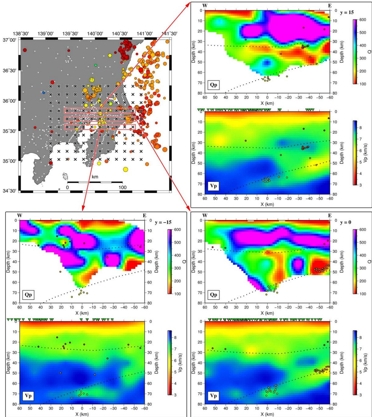
$Q_p$  と  $V_p$  の東西断面図。図中の破線はフィリピン海プレートと太平洋プレートの上面。丸は震源、逆三角は観測点を示す。
