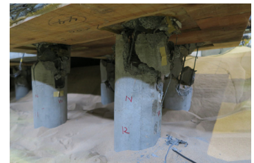
図 16 連成系加振での破壊状況
