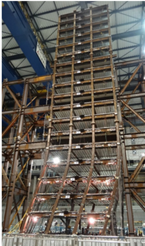
超高層鉄骨造建物の崩壊実験
