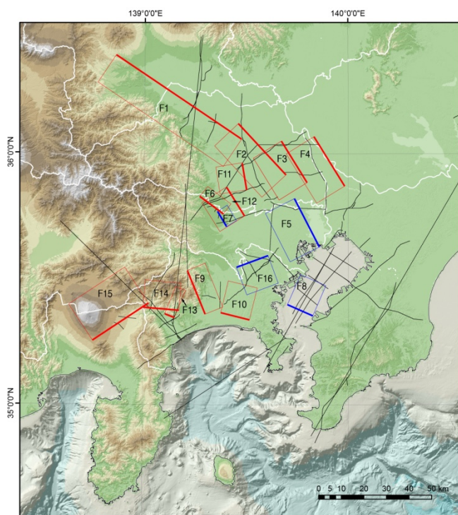
図 1 首都圏に分布する震源断層の矩形モデル。黒線は検討した反射測線の位置を示す。太線は断層面上端位置を示す。赤い矩形は下総層群の堆積期ないしは第四紀後期に活動した可能性のある断層、青色は上総層群を変形させる断層を示す。
