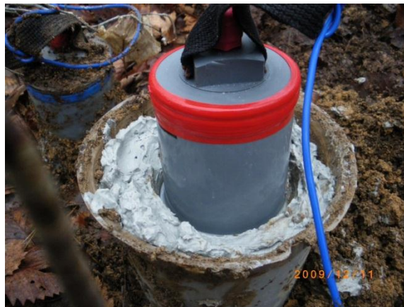
図 3. 不透水性カップに保湿剤 (ベントナイト) を入れ、その中に電極を埋め込んでカップごと設置する。
