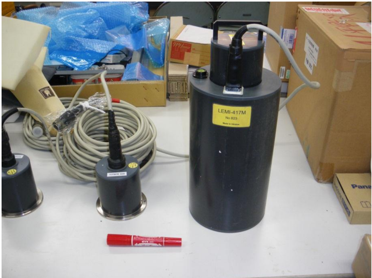
図 6. ジンバル無し LEMI-417 フラックスゲート磁力計(左)とジンバル付の同磁力計 (右)。
