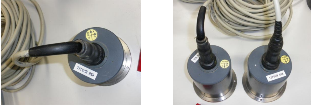
図 2. 左：対策前の磁力計。継ぎ手の部分に隙間がある。右：圧着スリーブを内部に取り付けると同時にブチルゴムテープによって防水処理が施された。
