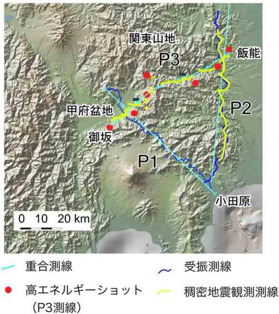
図 3 関東西部、伊豆衝突帯周辺の地殻構造探査測線図。P1: 小田原-山梨測線、P2: 関東山地東縁測線、P3: 飯能-御坂測線。
