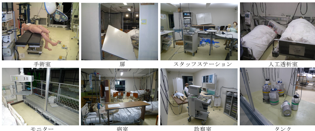
図 11 短周期地震動加振後の室内状況（耐震構造）
