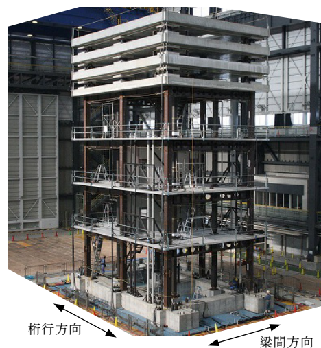
図1 骨組実験システムの全景
