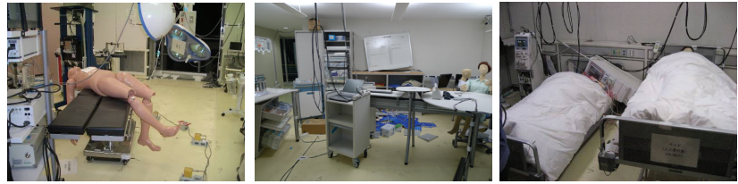
図3 耐震構造時被害状況（短周期地震動）
