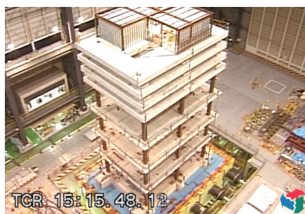
図 5 振動台上の試験体
