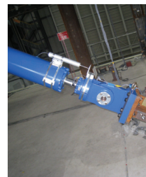
図 8 オイルの圧力を利用するダンパー
