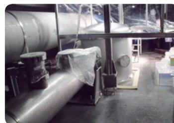
真空容器とそれにつながる真空パイプ。真空容器は高さ1.3m・直径1.2m。真空パイプは直径40cm。左奥はKAGRAの真空パイプで直径は80cm。
