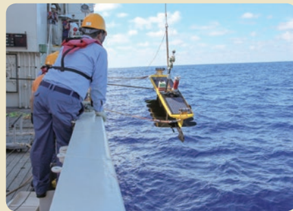
ウエーブグライダーの投入。燃料なしで、海の波を利用して進む。カメラとハイドロフォン(水中音波計)と空振計が搭載され、それらの電力は太陽光発電で賄う。(撮影:篠原雅尚)
