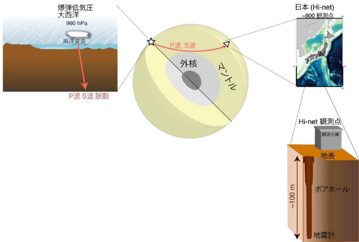
図 2 爆弾低気圧によって励起された地震波の伝播を示した模式図。
