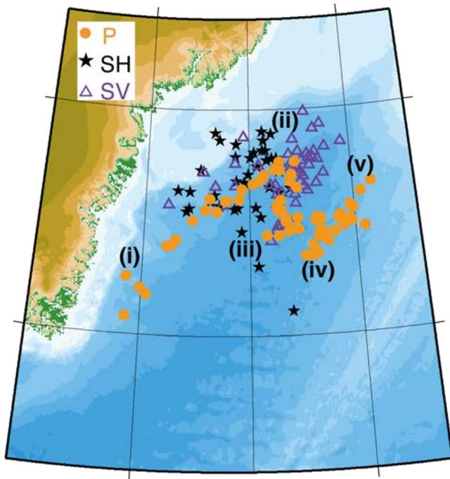
図 3 推定された P 波、SH 波、SV 波の震源位置。(i):12 月 9 日 0 時 (ii) 同 12 時 (iii) 12 月 10 日 0 時 (iv) 同 12 時 (v) 12 月 11 日 0 時 での P 波の震源の位置を示している。地図の色は水深を示しており、震源が等深線に沿って移動している様子が見て取れる。
