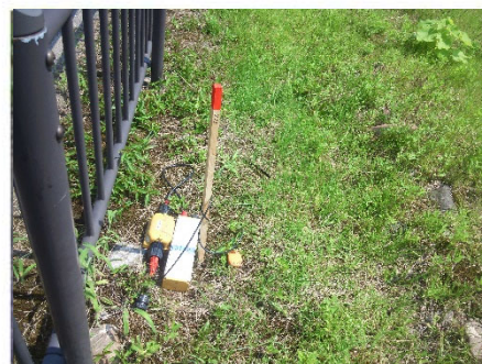
設置状態の小型地震計と レコーダ（独立型）
