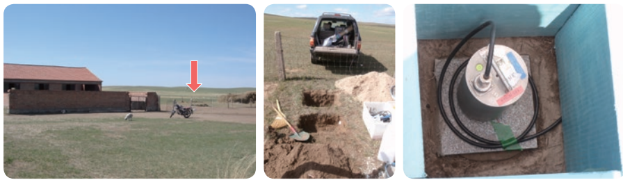
図2 観測点設置の様子 個人の家の庭先を借りて、穴を掘り、広帯域地震計と収録計を設置する。電源がない所では、太陽電池パネルを設置する。
