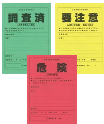
図1 応急危険度判定のステッカー
