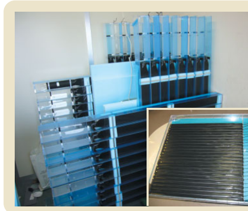
図3 製作中のリアルタイム観測が可能なミュオン検出器
