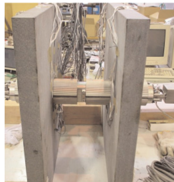
図 9：カップリング条件を変化させた加圧試験
