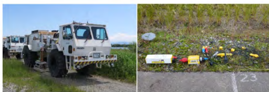
大型バイブレータ震源の稠密発振 独立型収録器の稠密・多数展開
